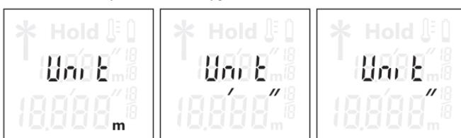
Удерживайте выключатель **(1)** в нажатом состоянии. Когда отобразится необходимая единица измерения, отпустите выключатель **(1)**. После отпускания измерительный инструмент включается с выбранной настройкой.
