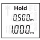
Нажмите выключатель **(1)** еще раз, чтобы снова остановить измерение. Лазерный луч выключается, и на дисплее отображается индикатор **HOLD**. В верхней строке отображается предыдущий результат измерения. В нижней строке отображается актуальный результат измерения, но он уже не актуализируется постоянно.
