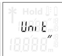
Açma/kapama tuşuna (1) uzun süre basın. İstenen ölçme birimi gösterildiğinde açma/kapama tuşunu (1) bırakın. Tuş bıraktığınızda ölçme cihazı seçilen ayarla açılır.
