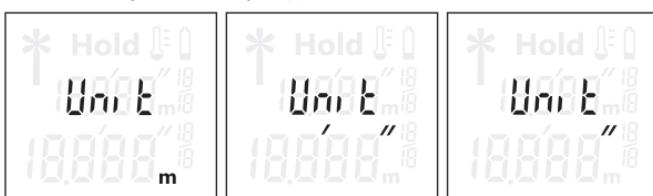
Довго натискайте на вимикач (1). Коли буде відображенна необхідна одиниця вимірювання, відпустіть вимикач (1). Після відпускання вимірювальний інструмент увімкнеться з обраним налаштуванням.
