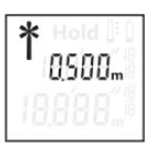
Снова нажмите выключатель **(1)**, чтобы опять включить лазер. Символ лазера
